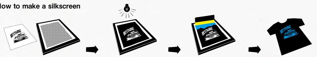
版下原稿と感光剤が塗られたスクリーンを用意する。
